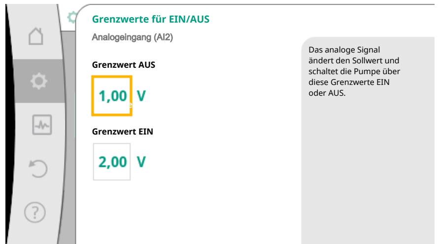
Fig. 74: Grenzwerte zur EIN/AUS-Steuerung über Analogsignale
